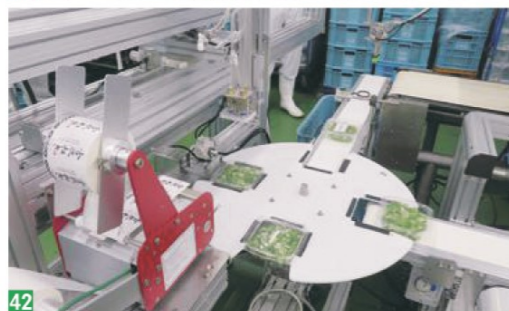
39 青ネギ専用カップ詰めライン。岡山県の「エネルギー効率化・新事業展開等による生産性向上支援事業補助金」を活用して盛り付け機やロボットなどを導入し、4人から1人に省人化した／40 カット済みの青ネギを選別しながらコンベヤに流す／41 ご飯計量・盛り付け機を改良し、おわんのようなざるでカップに青ネギを盛り付ける／42 ふたをしてラベルを貼る
