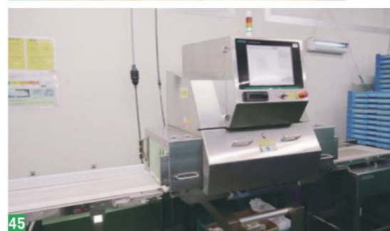
43 金属検出機を通過後、スカラロボットでコンテナに詰める。ラインの生産能力は1200パック/時 / 44 1階の出荷室。各部屋で出来上がった製品はここに集められる。上下階搬送には垂直搬送機(トレーリフター)を活用し、省力化を図る。昇降路に人が立ち入れない構造になっており、労働安全にも配慮されている / 45 出荷室に設置されたX線異物検出装置
