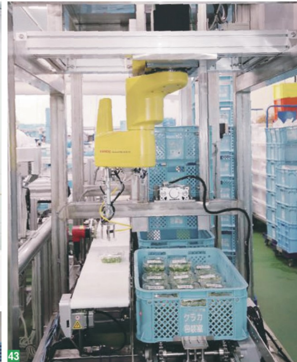
43 金属検出機を通過後、スカラロボットでコンテナに詰める。ラインの生産能力は1200パック/時 / 44 1階の出荷室。各部屋で出来上がった製品はここに集められる。上下階搬送には垂直搬送機(トレーリフター)を活用し、省力化を図る。昇降路に人が立ち入れない構造になっており、労働安全にも配慮されている / 45 出荷室に設置されたX線異物検出装置
