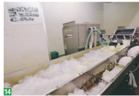
14 芯取り機でキャベツの芯を取り除き、外葉を剥がしながら茶枯れや虫の付着などの有無を確認する／
