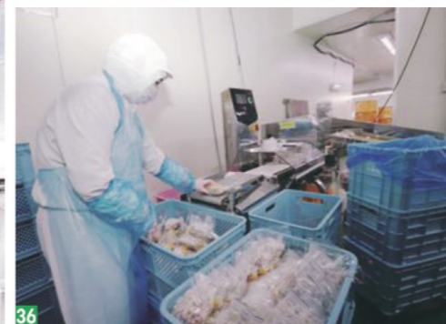
31 コンシューマーパックと一部業務用製品の包装ライン。自動で計量から充填・包装まで行う／32 袋詰めされたものは、金属検出機とウェイトチェッカーに通す／33 半製品を冷蔵庫で一時的保管／34,35 ミックスサラダのみを自動計量・充填・包装するライン。2400パック/時の生産能力を持つ／36 金属検出機とウェイトチェッカーに通す／37 セル生産用に製作した屋台を使い、袋詰め作業を行う／38 近隣の外食店向けに多品種少量のアイテムを袋詰め・セットする。日々異なる規格で高度な作業が求められるため、日本人スタッフのみで対応している
