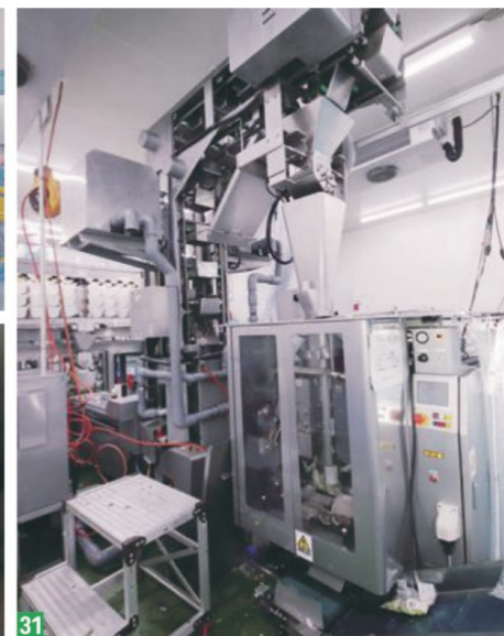
31 コンシューマーパックと一部業務用製品の包装ライン。自動で計量から充填・包装まで行う／32 袋詰めされたものは、金属検出機とウェイトチェッカーに通す／33 半製品を冷蔵庫で一時的保管／34,35 ミックスサラダのみを自動計量・充填・包装するライン。2400パック/時の生産能力を持つ／36 金属検出機とウェイトチェッカーに通す／37 セル生産用に製作した屋台を使い、袋詰め作業を行う／38 近隣の外食店向けに多品種少量のアイテムを袋詰め・セットする。日々異なる規格で高度な作業が求められるため、日本人スタッフのみで対応している
