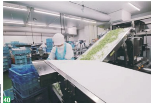
39 青ネギ専用カップ詰めライン。岡山県の「エネルギー効率化・新事業展開等による生産性向上支援事業補助金」を活用して盛り付け機やロボットなどを導入し、4人から1人に省人化した／40 カット済みの青ネギを選別しながらコンベヤに流す／41 ご飯計量・盛り付け機を改良し、おわんのようなざるでカップに青ネギを盛り付ける／42 ふたをしてラベルを貼る
